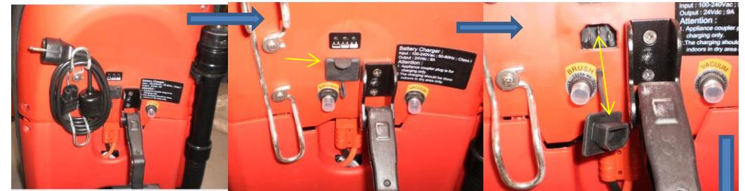
Подключить шнур одной стороной в машину другой в розетку 220 V. Когда загорится зеленый индикатор машина заряжена.
