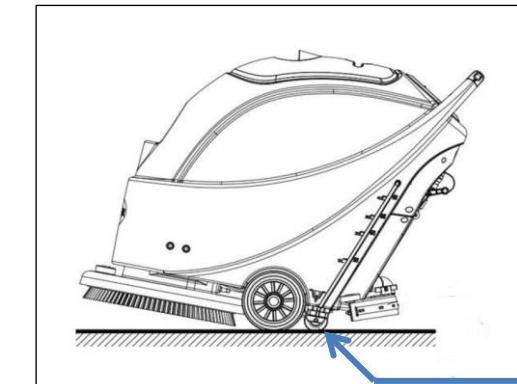
**Перевозить машину, наклонив на себя. Хранить машину только с открытой верхней крышкой!!!**
