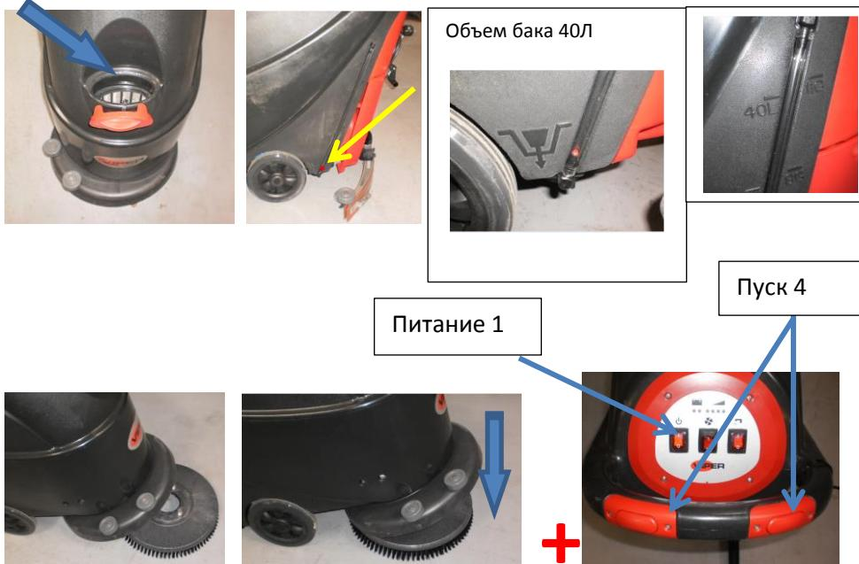
Одеваем щетку, нажимаем клавишу питания 1, клавишу включения вакуума 2, клавишу подачи воды 3. Затем на ручке управления нажимаем кнопку 4, машина начинает работать.
