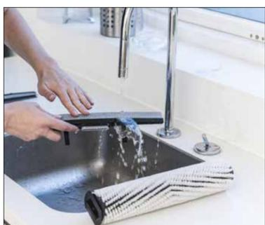
15. Очистить скребок и цилиндрическую щётку водой.
