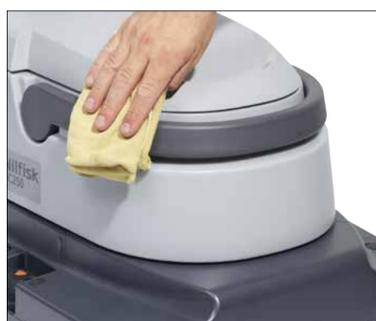
16. Очистить машину с помощью влажной ткани и (по необходимости) нейтрального очищающего средства.
