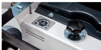
Регулируемое давление шлифовального круга
