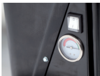
Вкл/Выкл + контроль избыточного давления
