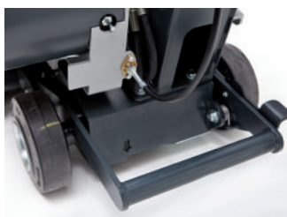
Педаль для установки машины в транспортное положение = быстрая перестановка машины
