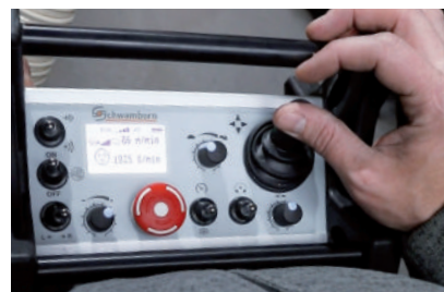
Пульт дистанционного управления для управления режимами движения и шлифования
