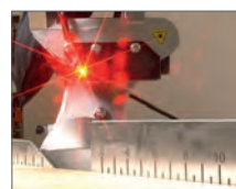
Лазерный указатель для высокой точности реза
