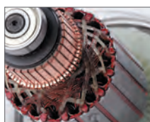
Арамидная нить для фиксации обмотки
