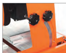
Система наклона для различных вариантов реза
